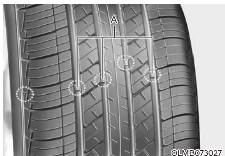
[A] : Indikator istrošenosti gaznog sloja
